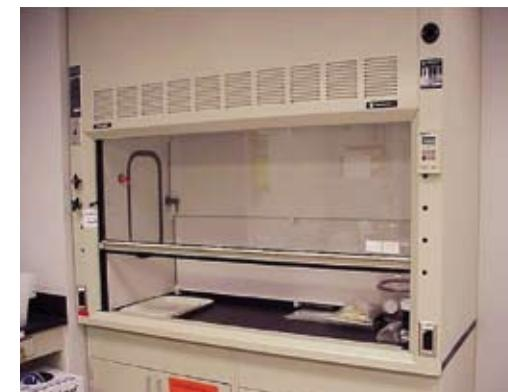
**Слика 39.** Типичан савремени дигестор (опремљен уређајем за одстрањивање испарења и заштитом од прскања)
