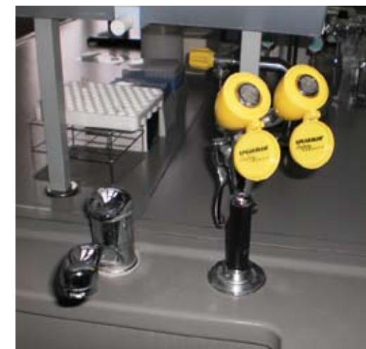
Слика 36. Апарат за испирање очију
