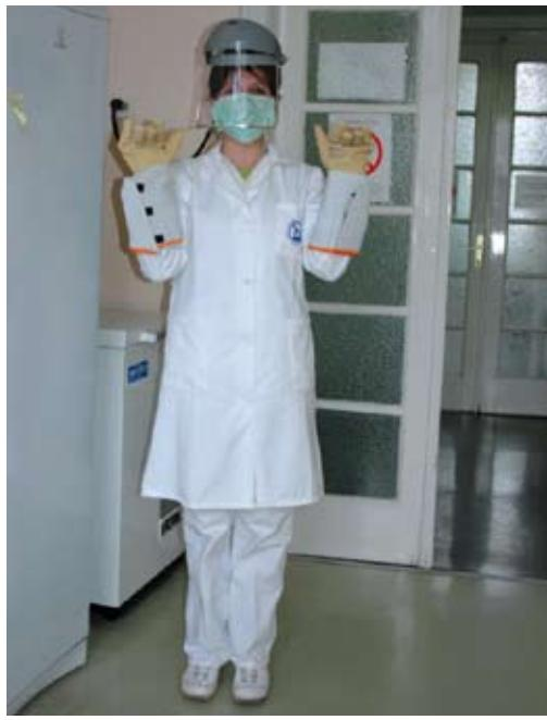
**Слика 54.** Специјална лична заштитна опрема за рад са течним азотом
